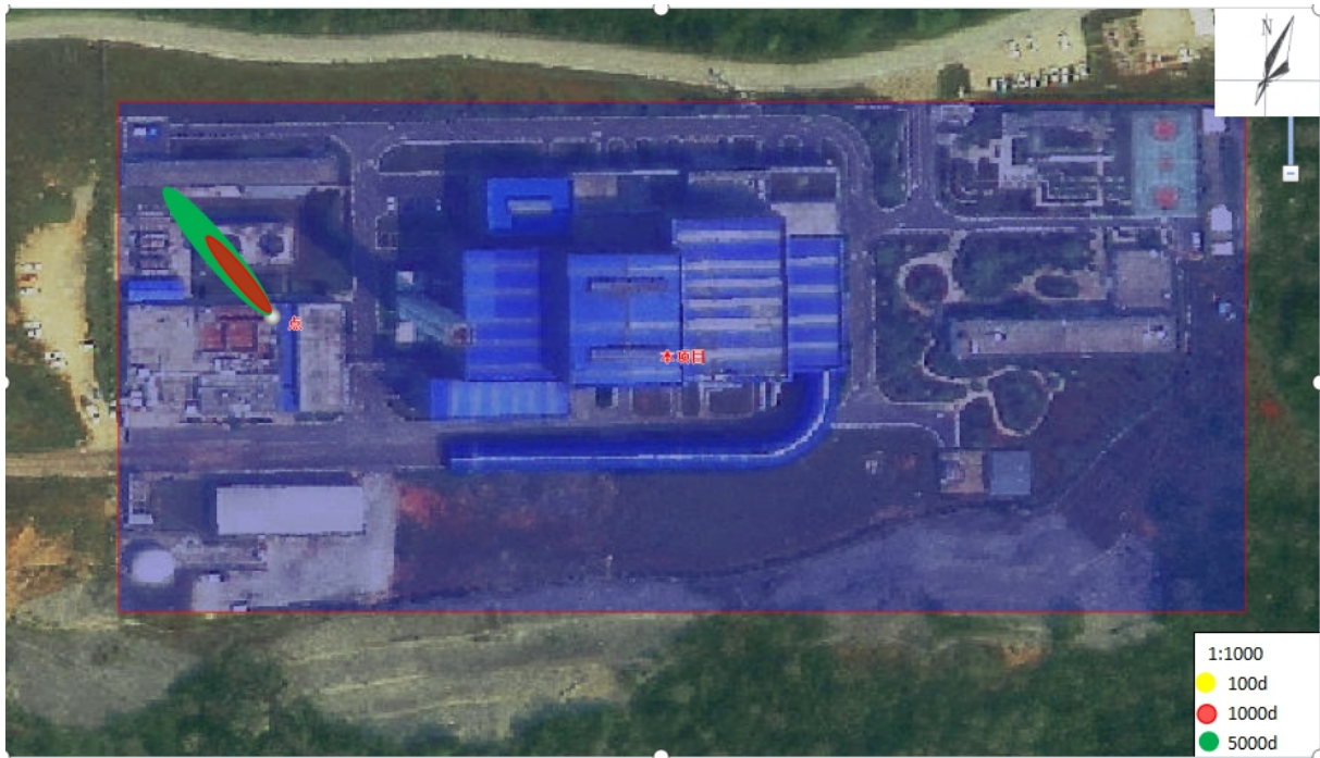
图 5.4-8 非正常工况调节池镉超标范围图
